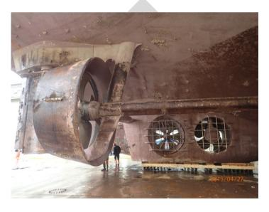
Commercial: PMTT1600, 1000kW and PMTT2000, 1600kW
